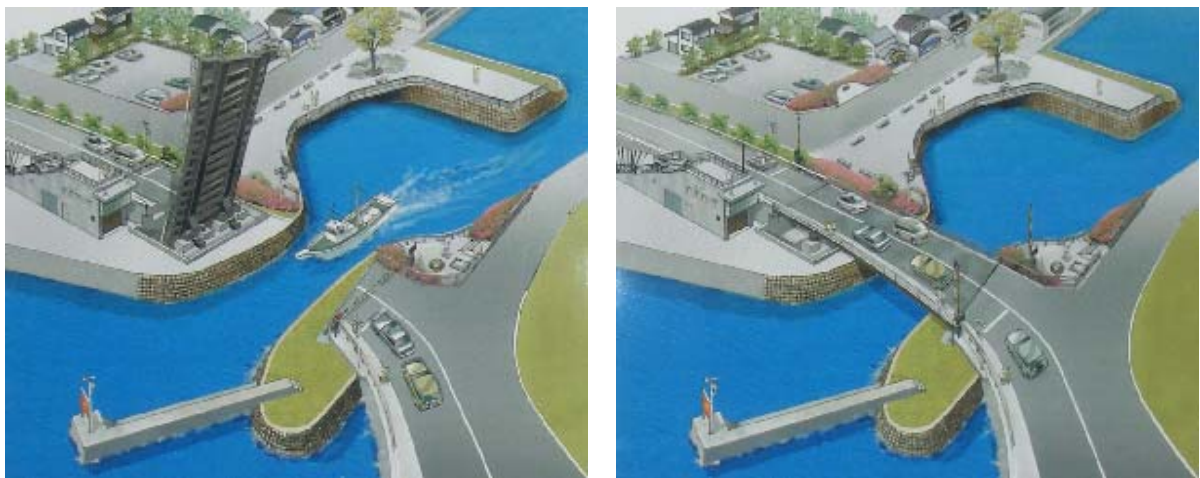
図1 手結港および可動橋イラスト（左：船舶航行可能時、右：車両通行可能時） （可動橋そばの説明用立て看板より）
